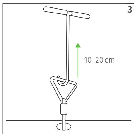
Ösen mit Lastverriegler um ca. 10–20 cm wieder hochziehen, bis Anker lastverriegelt sind
