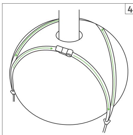
Spanngurt durch die Ösen über den Wurzelballen in die Ratsche führen
