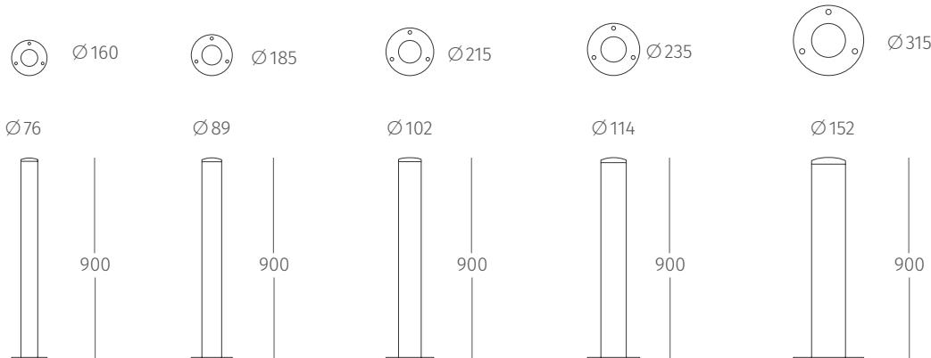
Ligada fest zum Einbetonieren
