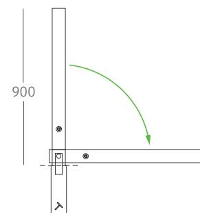
Barra fest zum Einbetonieren
